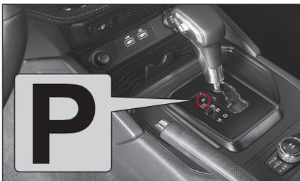
Устанавливайте рычаг в это положение при парковке автомобиля, а также во время запуска/прогрева двигателя и при длительной остановке.
