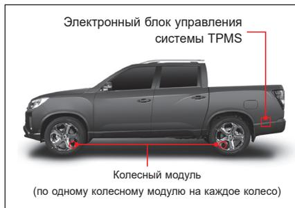
Электронный блок управления системы контроля давления в шинах принимает различные данные, включая сведения о давлении и температуре в шинах, с установленного на каждом колесе колесного модуля, и выводит эти данные на дисплей на приборной панели.
