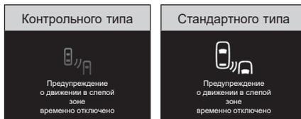
Если датчик не может нормально обнаружить зоны сзади и по обеим сторонам автомобиля с активированной системой предупреждения о ситуации сзади и по бокам, соответствующее сообщение отображается на дисплее приборной панели.
