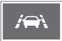
Когда система слежения за дорожной разметкой активирована, на приборной панели загорается контрольная лампа выхода из полосы.
