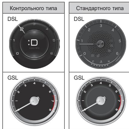
Указывает количество оборотов двигателя в минуту. Текущая частота двигателя получается при умножении указываемого значения на 1000.
