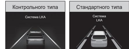
Если при движении автомобиля со скоростью 40 км/ч или более обнаружены обе линии полосы движения, оба указателя полосы движения на дисплее загораются зеленым цветом.
