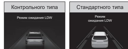
Когда автомобиль движется со скоростью менее 40 км/ч (условия низкой скорости) или не обнаружены обе линии полосы движения, маркер полосы движения затемняется.
