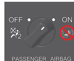
Подушка безопасности переднего пассажира отключена (не раскрывается) после установки данного выключателя в положение «OFF». Выключатель расположен на приборной панели справа, и его видно при открывании пассажирской двери. Нажмите и поверните выключатель в требуемое положение.
