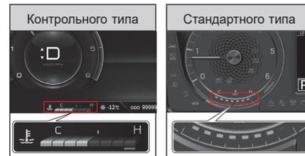
Температура охлаждающей жидкости двигателя.
