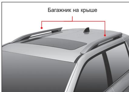
Перевозку багажа можно осуществлять с помощью багажного отделения на крыше.
