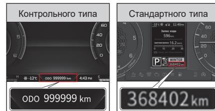
Общий пробег автомобиля в километрах.
