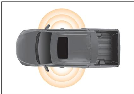
Перемещаясь на некоторое расстояние от автомобиля вместе со смарт ключом при закрытых дверях (включая дверь багажного отделения), все двери и дверь багажного отделения будут заблокированы и активируется система противоугонной сигнализации.
