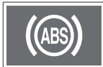
Сигнальная лампа загорается, если кнопка запуска/останова двигателя находится в состоянии ON, и гаснет, если система работает нормально.
