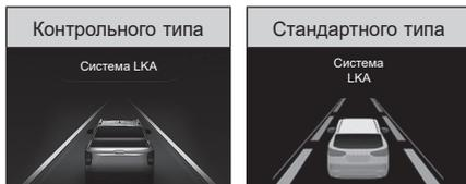
Если во время работы LKA ваш автомобиль приближается к любой стороне полосы движения без включения соответствующей контрольной лампы указателя поворота, соответствующий указатель полосы движения на дисплее будет мигать (зеленый ↔ красный).
