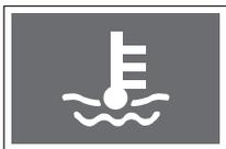
О перегреве двигателя может свидетельствовать включение сигнальной лампы перегрева двигателя и выходящий из моторного отсека пар.
