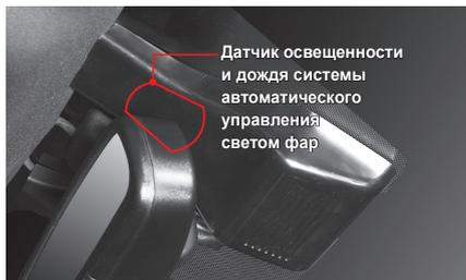
Датчик функции автоматического управления светом фар объединен с датчиком дождя.
