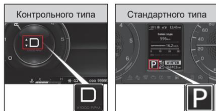
Текущее положение (P, R, N, D) рычага переключения передач и включенной передачи (1–6 ступень) в режиме М (ручной).
