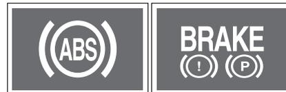
Если сигнальная лампа АБС и сигнальная лампа тормозной системы загораются одновременно, в системе EBD обнаружена неисправность. (Отдельной сигнальной лампы EBD нет).
