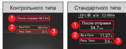
Отображается пробег, пройденный после запуска двигателя (км), время отъезда (чч:мм), время движения (чч:мм) и расход топлива (л).
