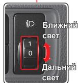
Наклон автомобиля вперед и назад может варьироваться в зависимости от числа пассажиров, массы и центра тяжести багажа.
