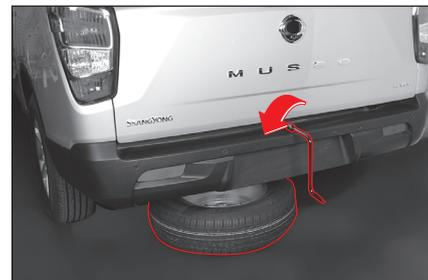
1 Откройте заднюю дверь и вставьте шатун в отверстие в центре верхней части бампера, затем подсоедините гаечный ключ для колесной гайки к шатуну.
