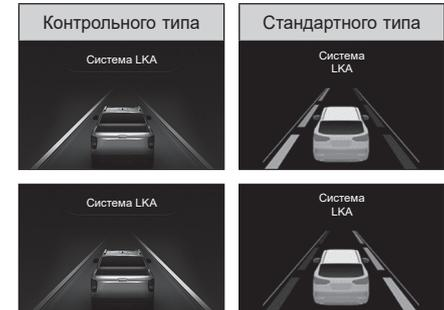
Если при движении автомобиля со скоростью 40 км/ч или более обнаружена только одна линия полосы движения, соответствующий маркер полосы движения на дисплее загорается зеленым цветом.
