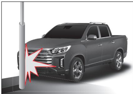
В случае столкновения с узким объектом, например с уличным фонарем, столбом освещения или деревом, степень удара может оказаться недостаточной для датчика, соответственно, подушка безопасности может не сработать.
