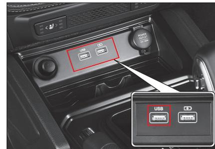
USB-накопитель, внешний музыкальный или видеоплеер, например, iPod/iPhone/iPad, проигрыватель MP3 могут быть подключены к системе автомобиля через USB-порт.
