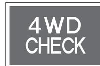
Сигнальная лампа «ПРОВЕРЬТЕ 4WD» загорается в случае неисправности переключателя 4WD.
