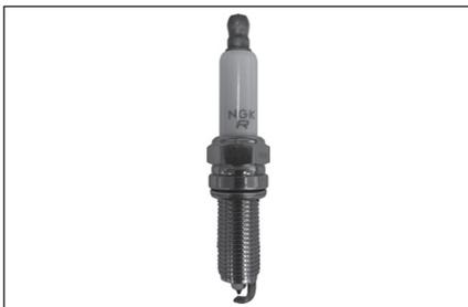
Свечи зажигания должны периодически проверяться на наличие нагара. Нагар на свече может препятствовать хорошему искрообразованию.
