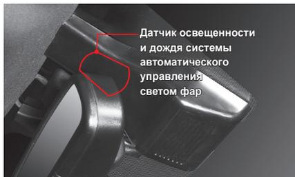
Датчик освещенности и дождя системы автоматического управления светом фар
