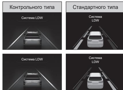
Если при движении автомобиля со скоростью 40 км/ч или более обнаружена только одна линия полосы движения, соответствующий маркер полосы движения на дисплее загорается зеленым цветом.
