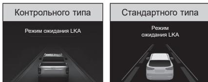
Когда автомобиль движется со скоростью менее 40 км/ч (условия низкой скорости) или не обнаружены обе линии полосы движения, маркер полосы движения затеняется.
