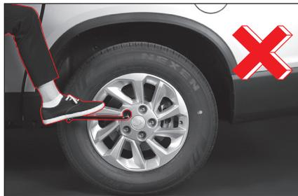
Слишком большое усилие, прикладываемое при затяжке, может привести к повреждению гаек. Не прикладывайте излишнее усилие к гайкам крепления колеса, наступая на ключ ногой или используя удлинитель ключа.
