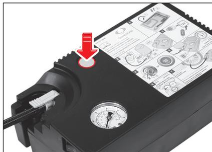
10 При достижении нужного давления нажмите выключатель питания (1) на ремонтном комплекте, чтобы отключить его.
