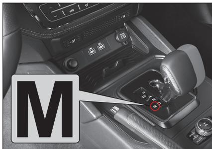
Переключение передач (1-6) можно произвести вручную аналогично механической коробке передач, переведя рычаг переключения передач из положения D (движение вперед) в положение М (ручной режим).
