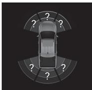
Если датчик обнаружения препятствий неисправен, для него отображается символ «?». Если на приборной панели отображается это сообщение, обратитесь за проверкой и обслуживанием автомобиля в ближайший авторизованный сервисный центр SsangYong.
