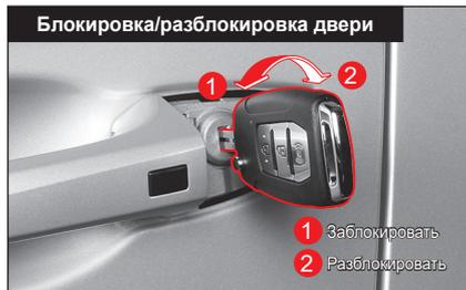
Вставьте аварийный ключ в соответствующее отверстие и поверните его против часовой стрелки, чтобы разблокировать дверь.
