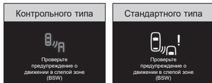
Когда система предупреждения о ситуации сзади и по бокам неисправна, отображается предупреждение на дисплее приборной панели.
