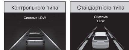
Включается, когда сигнал поворота не включен или автомобиль отклоняется от центра полосы движения.
