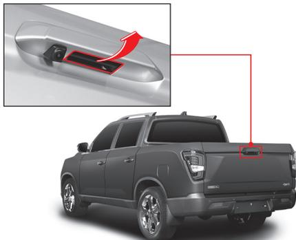
Для открывания заднего борта багажного отсека потяните ручку открывания борта и медленно опустите борт, поддерживая его обеими руками. После укладки багажа поднимите и закройте задний борт.
