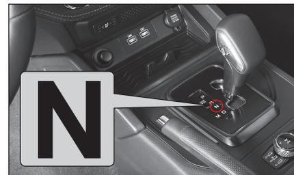
В этом положении рычага крутящий момент двигателя не передается на коробку передач.
