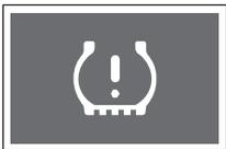
При нештатном давлении в шинах или неисправности системы контроля давления в шинах общая сигнальная лампа мигает, а затем горит непрерывно.
