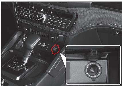
В салоне автомобиля установлена дополнительная розетка для подключения электроприборов. Питание к розетке подается, когда ключ замка зажигания находится в положении «ACC» или «ON».
