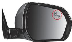
Если сигнальная лампа наружного зеркала заднего вида дважды мигает, когда кнопка запуска/останова двигателя находится в состоянии ON, или когда работает двигатель, это указывает на нормальную работу системы предупреждения о ситуации сзади и по бокам.
